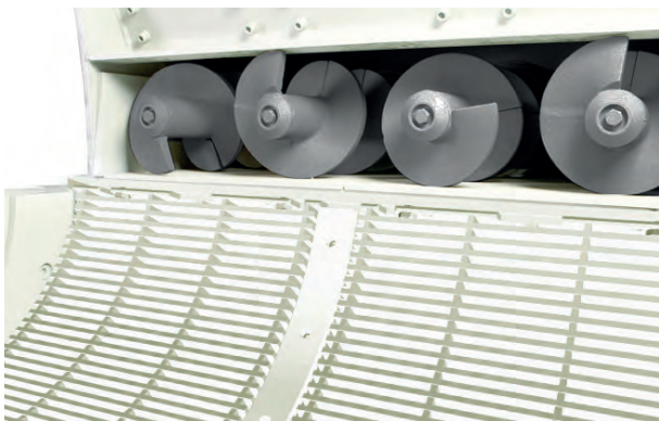
1 Área de cribado con barrotes / Зона просеивания с колосниками
