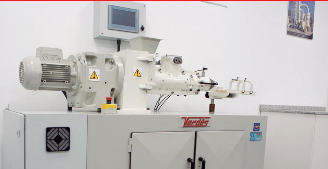
Conjunto integrado por la extrusora, accionamientos, mesa de corte y bomba de vacío.
