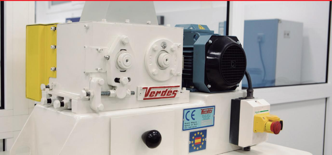
Diseñado para moler materiales húmedos o semi-húmedos, este desintegrador reproduce el principio de funcionamiento de la serie de desintegradores Verdés.
