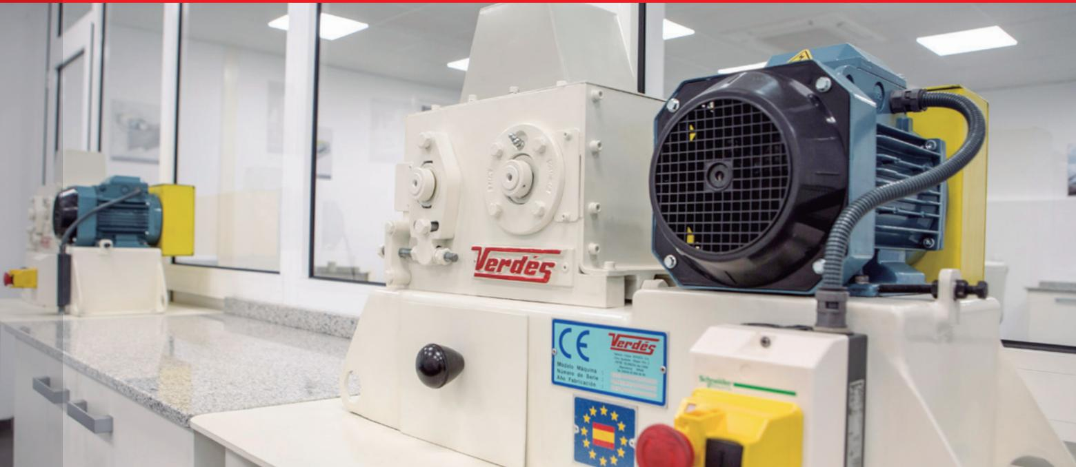
Este equipo sigue el mismo concepto de laminado que las máquinas de escala industrial. Es decir, dos cilindros lisos que trabajan el uno contra el otro a distinta velocidad con una separación regulable de hasta 5 mm.
