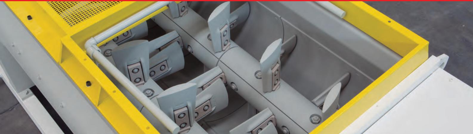
Zona de amasado destinada a la homogeneización de los diferentes componentes, arcillas y aditivos.
