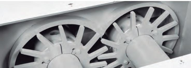
*Звёздочки и гребёнки экструдированного смесителя способствуют равномерному выходу массы, разрезая её на равноразмерные куски, что облегчает процесс последующей переработки.*
