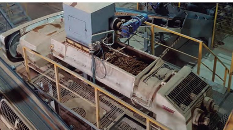
Смеситель предназначен для того, чтобы добиться однородности керамической массы, равномерного распределения добавок, обладающих разными характеристиками (текстурой, плотностью и т.д.), он позволяет эффективно и равномерно увлажнять массу, обеспечивает усреднённый возврат в линию обреза, образующейся при резке после формовки изделий.
