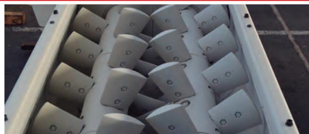
Diseñadas para obtener una homogeneización y una calidad de la mezcla superior, garantizando una perfecta cohesión de los materiales, a la vez que una óptima incorporación de aditivos de distintas texturas y densidades, así como una humectación más eficaz o inclusive la reincorporación efectiva de recortes procedentes del área de moldeo.
