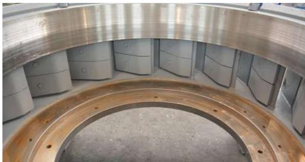
Благодаря особой геометрии кожуха и распылителя, поток воздуха равномерен внутри всей помольной камеры, при этом перерабатываемый материал равномерно распределяется по всей поверхности рабочего кольца.
