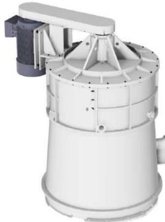
Классификаторы «Альфа» специально предназначены для сепарации минеральных частиц размером от 15 до 200 микрон. Верткальный ротор, прочно соединенный со статором, размещается в прочном корпусе сепаратора. Высокая рабочая скорость позволяет обеспечивать большую точность резки, высокий КПД, низкие затраты.
