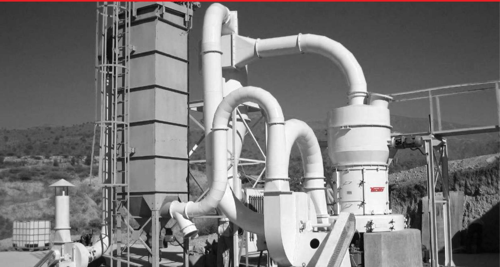
El diseño del Molino Pendular nació de la necesidad de obtener partículas finas de una forma más eficiente respecto a las tecnologías disponibles en aquellos momentos. Siendo un sistema altamente probado y fiable, hoy en día se utilizan en varias aplicaciones en diferentes industrias para procesar de forma económica y eficaz una enorme variedad de materiales.
